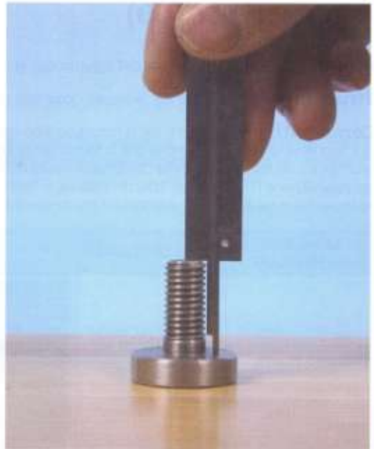
5 Misura dell'altezza del gambo della vite effettuata utilizzando l'astina di profondità del calibro. Durante questa operazione occorre che l'astina sia tenuta ben aderente al filetto, in modo da risultare perfettamente perpendicolare al piano. Tale misura può anche essere ricavata per differenza, misurando la lunghezza totale del pezzo e lo spessore della testa.
