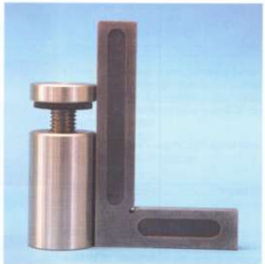
7 Controllo della perpendicolarità tra la base del cilindro e la superficie laterale, tramite una squadra posta in verticale appoggiata al pezzo. È necessario che la superficie di riscontro sia perfettamente piana.
