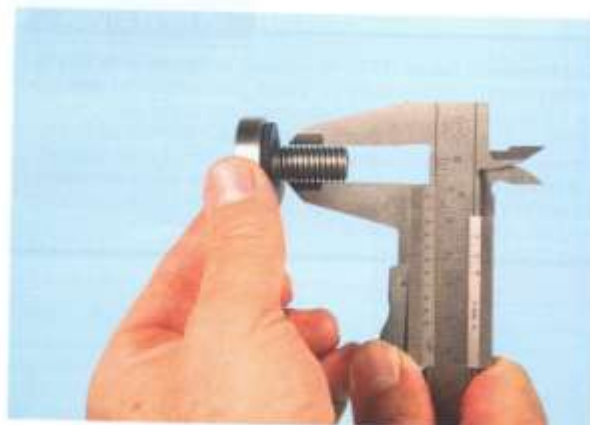
3 Misura del diametro del filetto della vite: i becchi del calibro devono essere ben appoggiati paralleli all'asse della vite, posizionati sul diametro e non su una corda. Il controllo della filettatura si può eseguire anche con calibri (penni) filettati campione.
