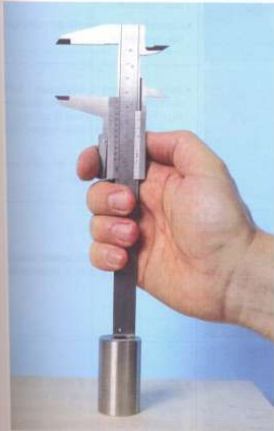
6 Misura della profondità della filettatura interna del cilindro tramite l'astina di profondità. Anche in questo caso è importante che l'astina sia ben aderente al filetto interno del cilindro.
